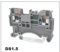
DS1.5 500V/17.5A 0.2-1.5mm 2 600V/15A 26-14AWG T/W/End plate 3.5/45/1.5mm
