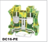
DC16-PE — 1.5-25mm 2 — 12-4AWG T/W/End plate 12/41/1.5mm
